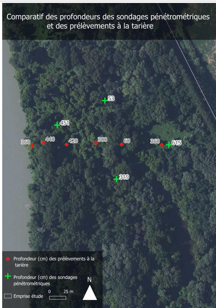
Figure 12 : comparaison des profondeurs des sondages pénétrométrique et des prélèvements à la tarière
