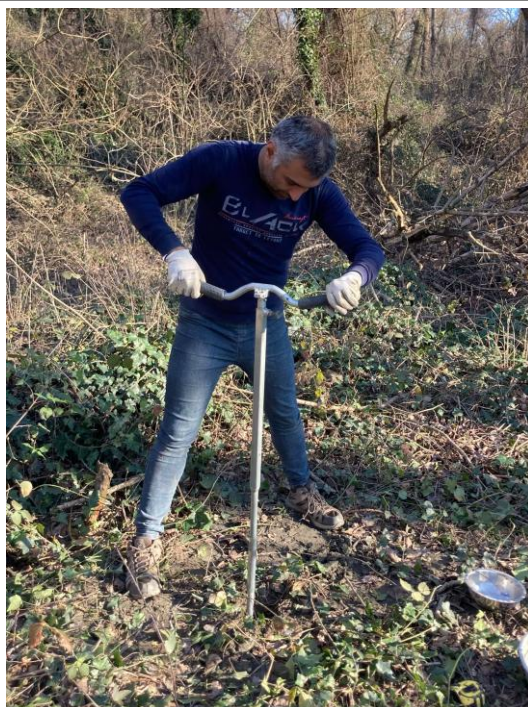
Figure 10 : Opérateur effectuant un carottage avec une tarière manuelle
