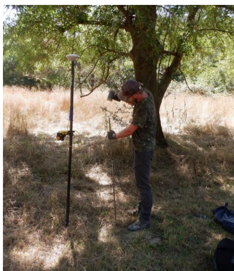
Figure 7 : Opérateur enfonçant un train de tiges
